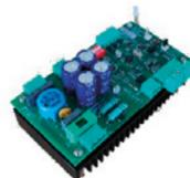
**E405002 Platine für Auslösersteuerung**
